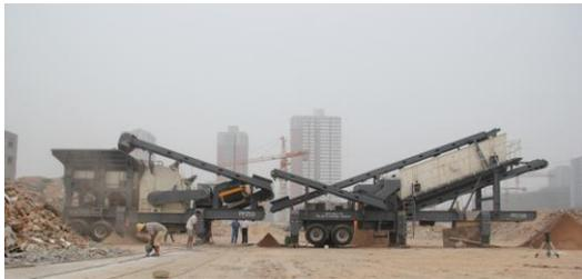
再生粒料绿色制备的移动装备新技术，研究适应不同工况废弃物的专用破碎腔型，研制研磨架可调的反击式破碎机；研究轻物质分离技术，采用“预筛+风选”双重分离技术，研制“风力物料分离器”；研究粒料制备工艺，按功能模块集成移动式装
