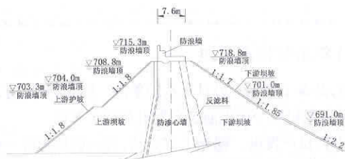
图1 坝顶剖面图(单位:m)
