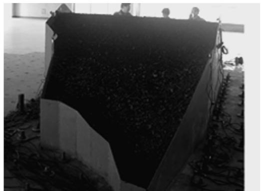
图6 下游坝坡的破坏
