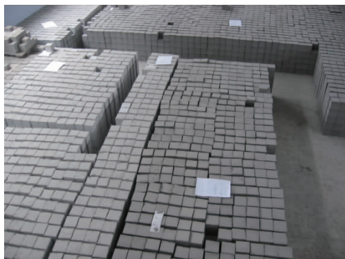
图 6 不同类别岩体模型材料块体
