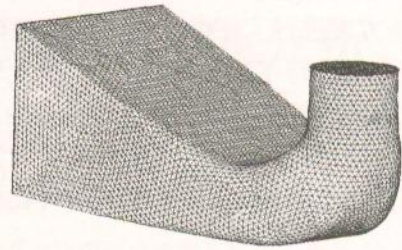
图 2 肘形进水流道网格剖分
