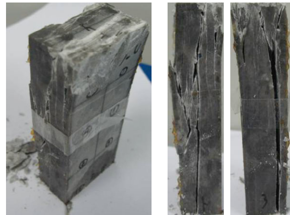
(d) JP_RB_6 大理岩岩样板裂化破坏
